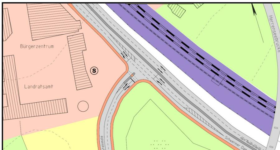
Bild 8: Variante 5, Knotensskizze B 192/Steinmole
